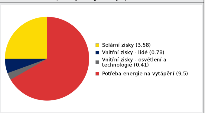
Bilance potřeby energie na vytápění (MWh/rok)
